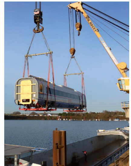
Eine logistische Glanzleistung: Ein Schwerlastkran der Firma Felbermayr verlädt am Wendebcken einen 62 Tonnen schweren Velaro-Wagon, der im Uerdinger Siemens-Werk gebaut wurde, in das Schiff.
